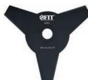
Для скоса травы и тонких веток кустарников. Три лопасти. Лезвия с двумя режущими кромками. Посадочный диаметр 25,4 мм. Материал: инструментальная сталь с черным покрытием. Упаковка: картонный конверт.
