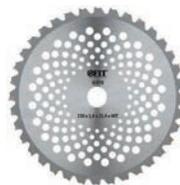
Для скоса и измельчения травы, кустарников и тонких стволов деревьев. Посадочный диаметр 25,4 мм. Толщина режущей кромки 2,0 мм. Материал: инструментальная сталь, карбидные режущие вставки. Упаковка: картонный конверт.
