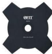
Для скоса травы и тонких веток кустарников. Четыре лопасти. Лезвия с двумя режущими кромками. Посадочный диаметр 25,4 мм. Материал: инструментальная сталь с черным покрытием. Упаковка: картонный конверт.
