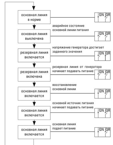
T1 – время задержки передачи. Контроллер можно настроить 0–30 сек. при аварийной ситуации с основным источником питания, время перед разрывом (разъединением) QN
