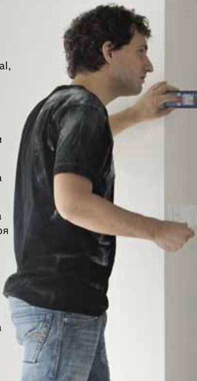
В комбинации с измерительной линейкой R 60 Professional GLM 80 Professional превращается в цифровой ватерпас: вы можете измерять расстояния, выполнять нивелировочные работы и точное измерение уклонов с одним и тем же инструментом.
