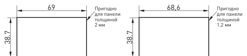
Установка винтов: чертеж с размерами прорези в панели
