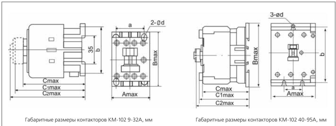
Габаритные размеры контакторов KM-102 9-32A, мм
