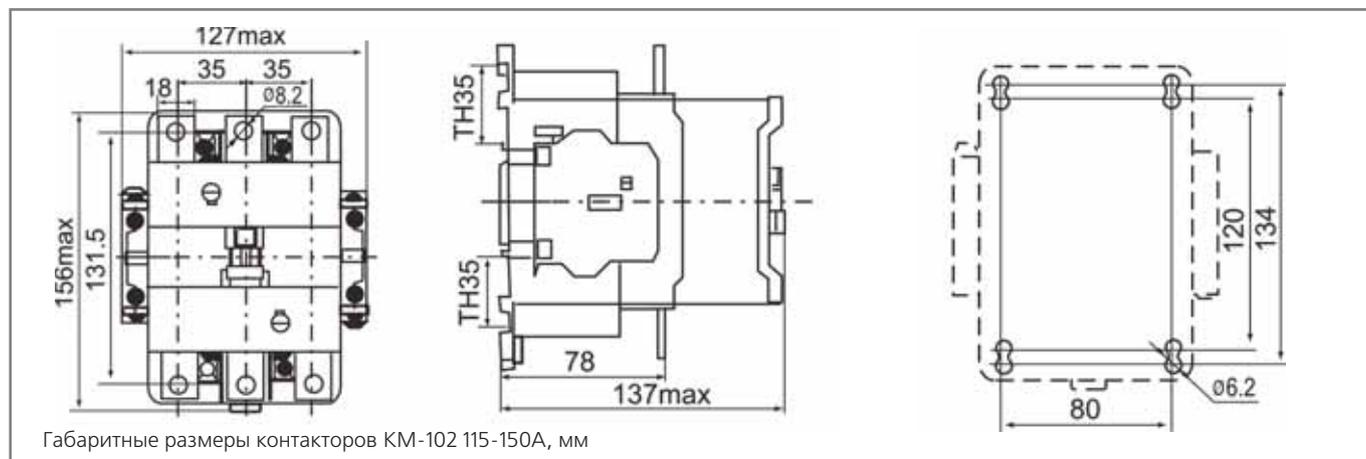
Габаритные размеры контакторов KM-102 115-150A, мм
