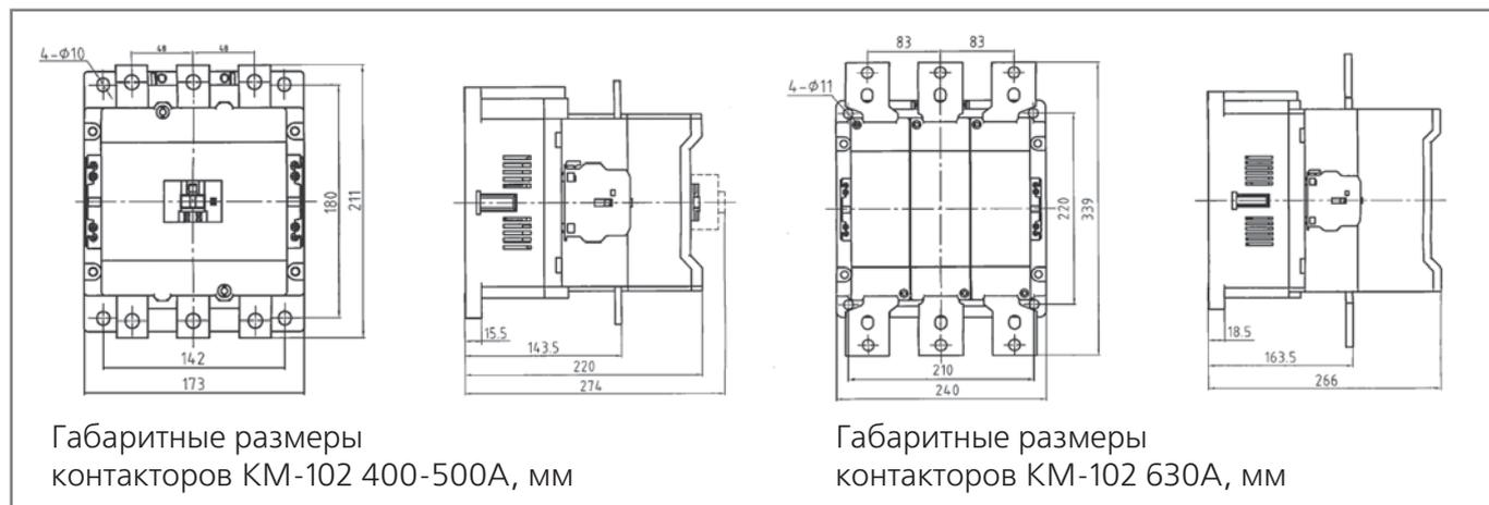
Габаритные размеры контакторов KM-102 400-500A, мм
