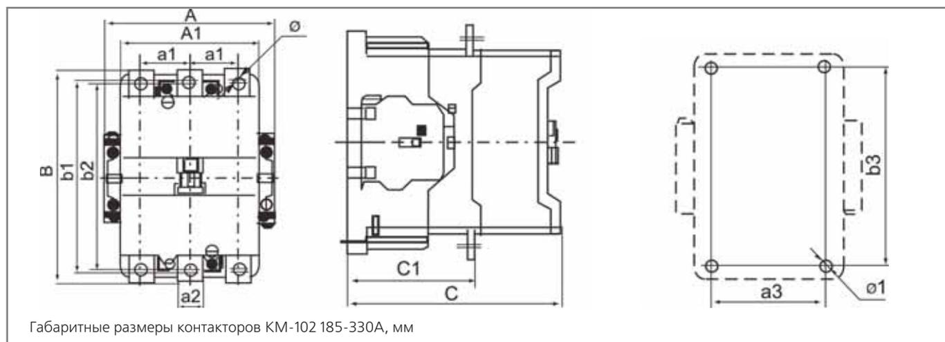
Габаритные размеры контакторов KM-102 185-330A, мм
