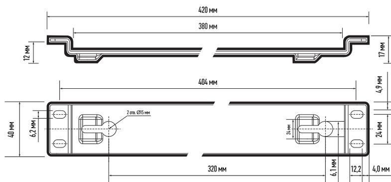
Схема Кронштейна потолочного PPI-03 150/200w
