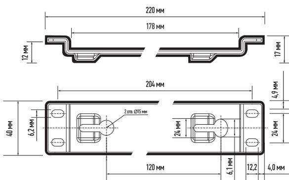
Схема Кронштейна потолочного PPI-03 100w
