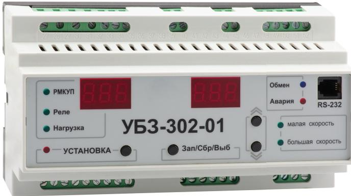
Универсальный блок защиты асинхронных электродвигателей OptiDin УБЗ-302-01 предназначен для защиты двухскоростных (двухобмоточных) двигателей, постоянного контроля параметров сетевого напряжения, действующих значений фазных/линейных токов и проверки значения сопротивления изоляции электродвигателей.
