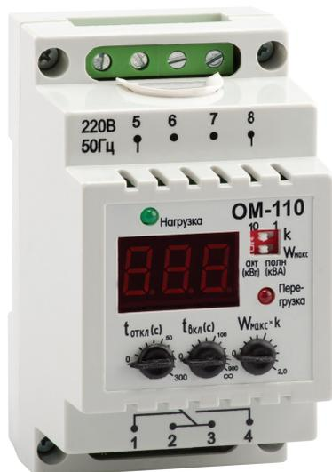
Реле ограничения мощности OptiDin OM-110 предназначено для постоянного контроля активной или полной мощности однофазной нагрузки. Измеряемый диапазон мощности от 0 до 20 кВт или от 0 до 20 кВА. OptiDin OM-110 выполняет отключение нагрузки в случае превышения заданного пользователем уровня максимально допустимой мощности потребления нагрузки (с заданным временем отключения) и последующим автоматическим включением (с заданным временем задержки включения или с блокировкой повторного включения).
