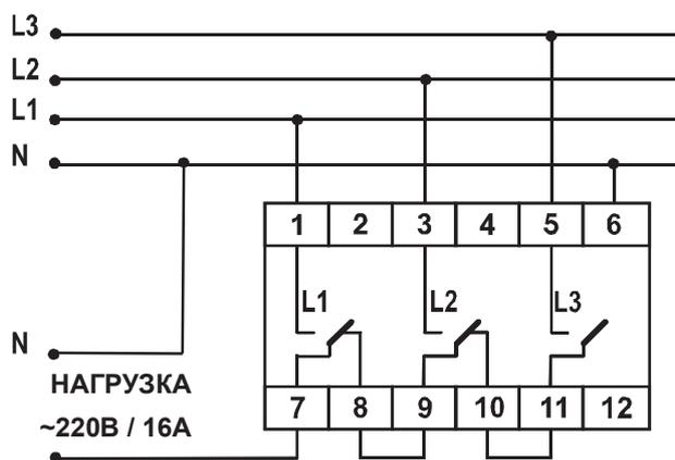
Схема подключения OptiDin ПЭФ-301 при величине нагрузки более 16 А с использованием магнитных пускателей или контакторов
