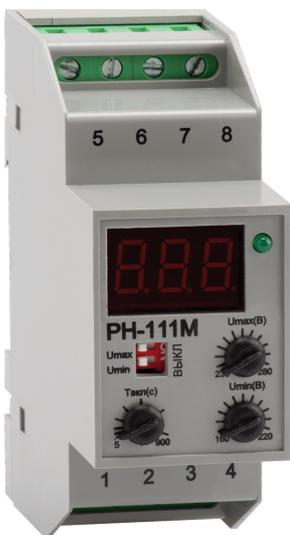
Реле OptiDin PH-111M предназначено для отключения бытовой и промышленной однофазной нагрузки 220 В, 50 Гц при недопустимых колебаниях напряжения в сети с последующим автоматическим включением после восстановления параметров сети.
