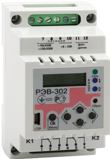
Многофункциональное реле OptiDin РЭВ-302 представляет собой микропроцессорное программируемое устройство и предназначено для включения/отключения нагрузки в предварительно установленные пользователем моменты времени с учетом сетевого напряжения и освещенности внешнего фотодатчика.
