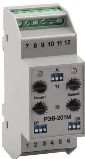
Двухканальное реле времени с задержкой на включение OptiDin РЭВ-201М предназначено для коммутации электрических цепей переменного тока 220 В/50 Гц и постоянного тока 24-100 В с регулируемой задержкой времени включения от 0 до 36000 с.
