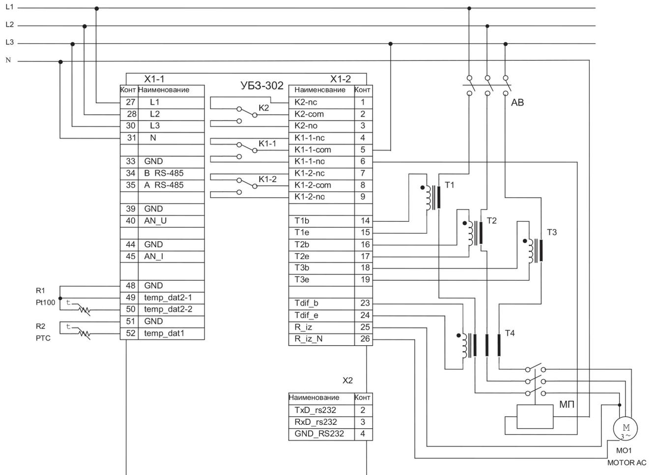
Реле K1 – реле нагрузки
