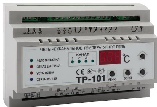
Цифровое температурное реле OptiDin TP-101 предназначено для измерения и контроля температуры устройства по четырем независимым датчикам, подключаемым по двух- или трехпроводной схеме, с последующим отображением температуры на дисплее. Устройство может быть использовано в различных отраслях промышленности, коммунального и сельского хозяйства.
