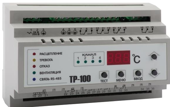
OptiDin TP-100 предназначено для измерения и контроля температуры устройства по четырем датчикам РТ100, подключаемым по двух- или трехпроводной схеме, с последующим отображением температуры на дисплее и выдачей сигналов тревоги при выходе каких-либо параметров за установленные пределы.
