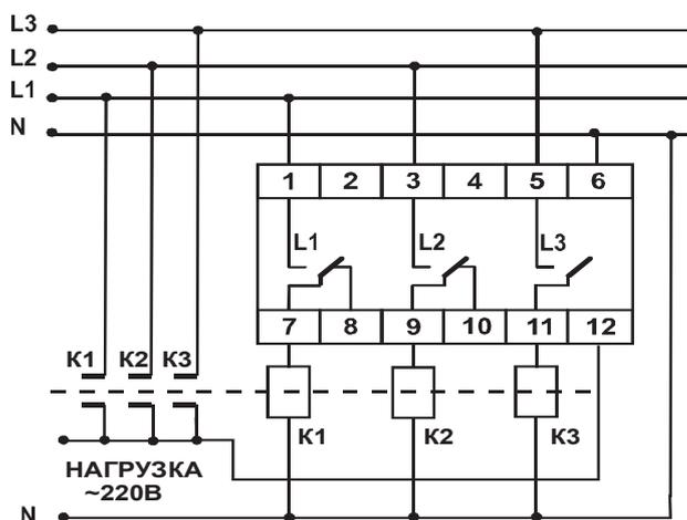
В OptiDin ПЭФ-301 предусмотрена внутренняя блокировка от залипания контактов выходных встроенных реле, а также контроль состояния силовых контактов МП во внешней цепи (блокировка от их залипания, используется клемма 12).
