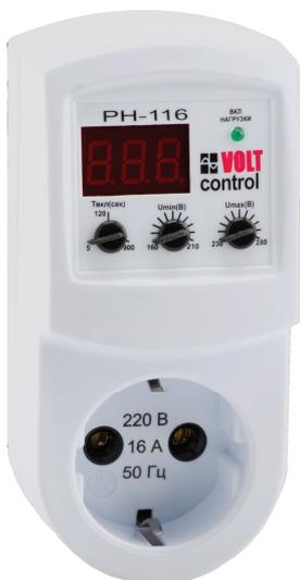
Реле напряжения OptiDin PH-116 предназначено для отключения бытовой и промышленной однофазной нагрузки 220 В, 50 Гц мощностью до 3,5 кВт (до 16 А) при недопустимых колебаниях напряжения в сети с автоматическим повторным включением (в дальнейшем АПВ) после восстановления параметров сети.
