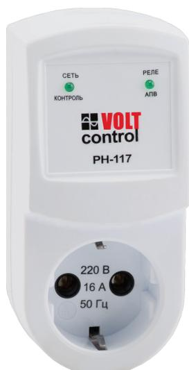
Реле напряжения OptiDin PH-117 предназначено для отключения бытовой и промышленной однофазной нагрузки 220 В, 50 Гц мощностью до 3,5 кВт (до 16 А) при недопустимых колебаниях напряжения в сети с автоматическим повторным включением (в дальнейшем АПВ) после восстановления параметров сети. OptiDin PH-117 индицирует соответствие напряжения электрической сети действующим стандартам, состояние аварии и состояние выходного реле.
