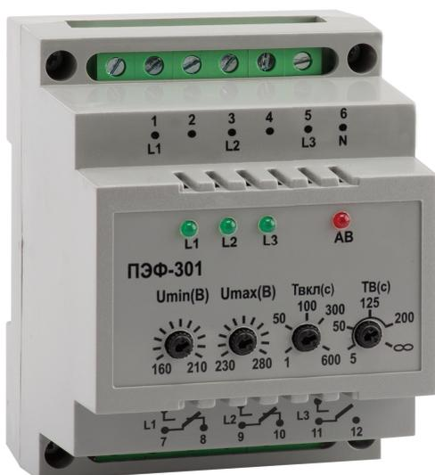
Универсальный автоматический электронный переключатель фаз OptiDin ПЭФ-301 предназначен для питания промышленной и бытовой однофазной нагрузки 220 В/50 Гц от трехфазной четырехпроводной сети 3х380+N с целью обеспечения бесперебойного питания особо ответственных однофазных потребителей и защиты их от недопустимых колебаний напряжения в сети.
