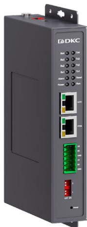
N3000 – серия промышленных преобразователей протоколов и интерфейсов, разработанных специально для систем передачи данных для приложений промышленной автоматизации, используется для преобразования промышленных сетей, протоколов в сеть Ethernet. N3000 поддерживает TCP, UDP, HTTP, ARP, ICMP, LLDP, SNMP, FTP, TFTP, Syslog, SMTP, DNS, DHCP и различные промышленные протоколы. Могут быть сконфигурированы через веб-интерфейс или специализированное Windows-программное обеспечение.
