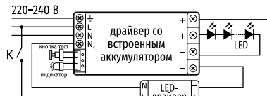
Схема подключения БАП в светильнике NBL-P-LED-A1
