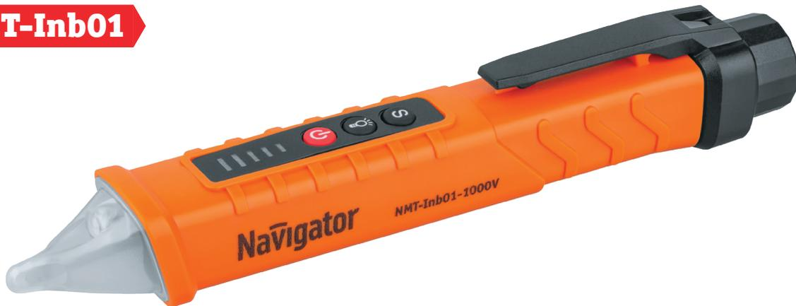
**Индикатор напряжения Navigator NMT-Inb01** предназначен для определения напряжения бесконтактным способом, фазной и нулевой жилы. Прибор работает в двух диапазонах чувствительности: 12–1000 В и 48–1000 В.
