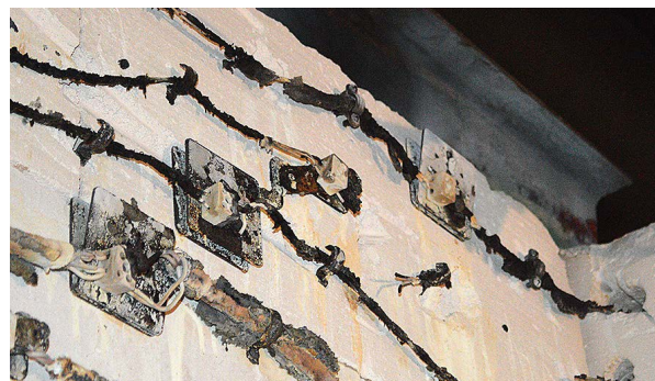
Рис. 2. Кабельные линии до и после испытания.
