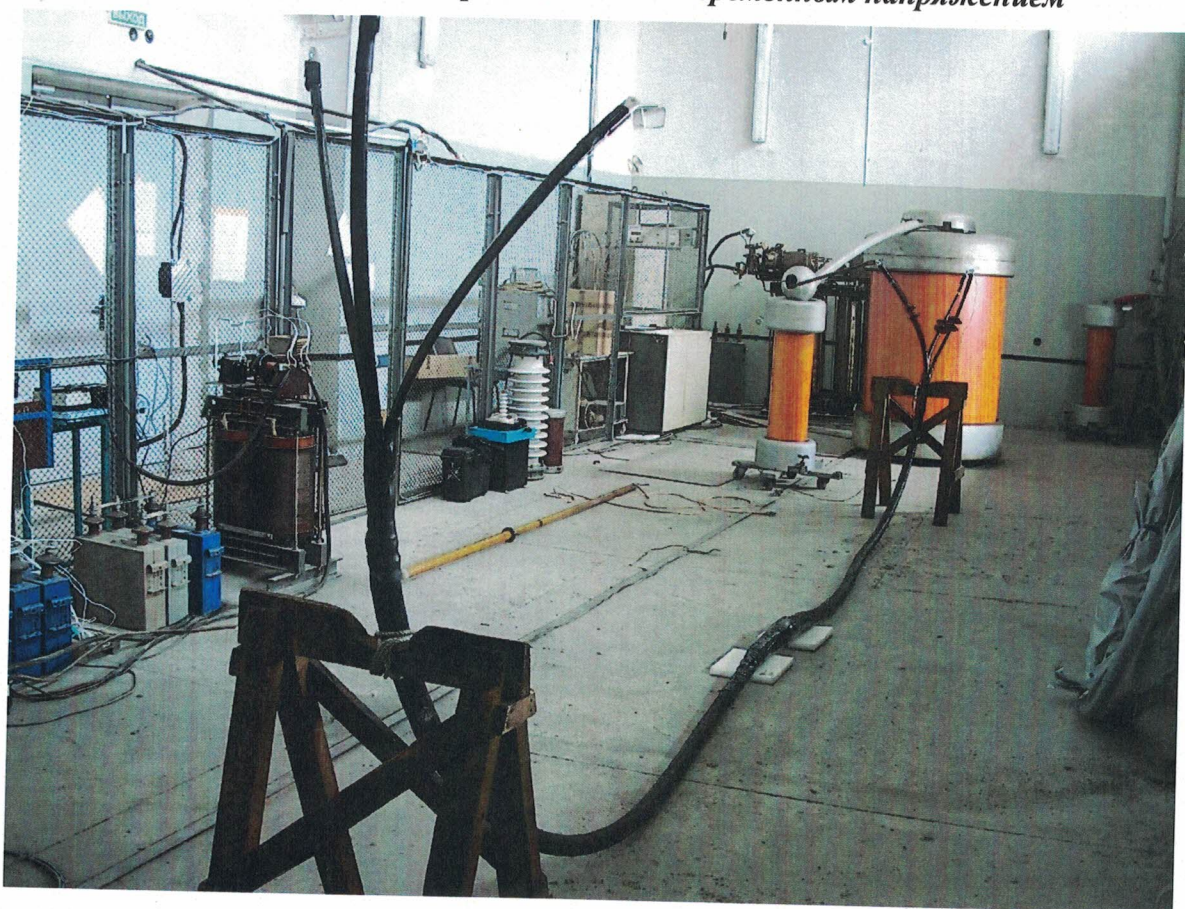
Образец с муфтами при испытании постоянным напряжением
