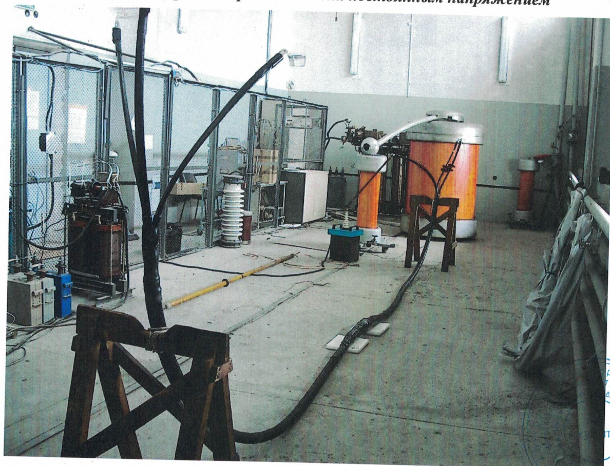
Образец с муфтами при испытании постоянным напряжением
