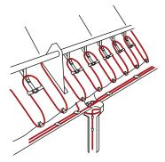
Основным компонентом систем являются нагревательные кабели. Для обеспечения стока талой воды они укладываются в водосточной системе, а для предотвращения схода снежных масс устанавливаются на краю кровли вместе с снегозадерживающими элементами.
