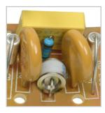
Два варистора обеспечивают защиту от импульсных перенапряжений.
