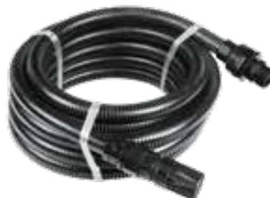
Применяются в качестве входной магистрали поверхностных насосов. Шланги армированы пластиковой спиралью. На одном конце шланга установлен съемный обратный клапан с сетчатым фильтром, на другом конце – разборный соединительный фитинг для соединения с насосом.
