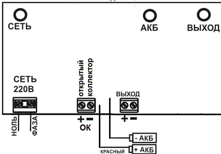
Рисунок 1. Вид источника с открытой крышкой (схема подключения)
