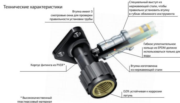
ПВДФ пресс-фитинги HENCO отлиты из фторопласта ПВДФ (поливинилиденфторид), имеют уплотнения из высококачественного каучука EPDM, пресс гильзы из нержавеющей стали с выступом для центровки в пресс-инструменте с функцией «детекции протечки». Резьбовые вставки выполняются из коррозионностойкой латуни DZR.
