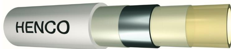
Многослойная М труба HENCO RIXc состоит из сваренной встык алюминиевой трубы с внутренним и внешним слоями из сшитого полиэтилена ПЭ-С полученного экологически безопасным электронным методом сшивки. Слои соединены друг с другом с помощью высококачественного клея. Труба может поставляться предварительно изолированной или помещенной в защитную гофру.
