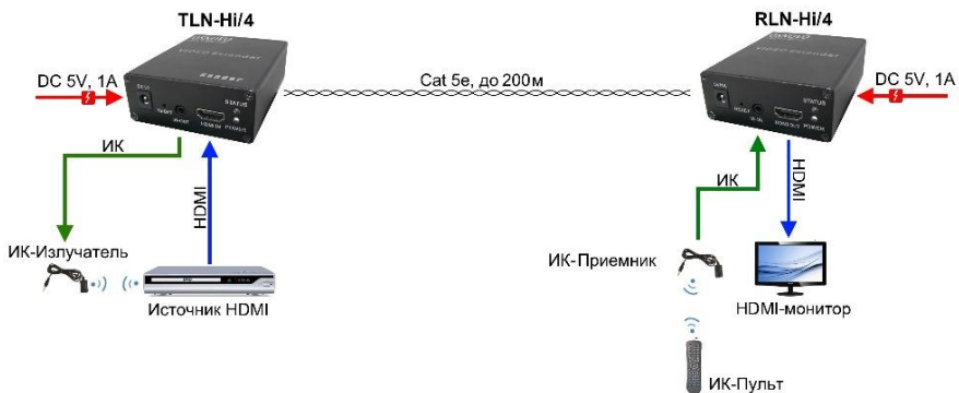
Рис.4 Схема подключения передатчика TLN-Hi/4 и приемника RLN-Hi/4 «точка-точка».
