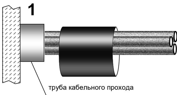
Надвинуть на конец кабелей (кабеля) полиэтиленовый пакет от упаковки термоусаживаемой трубки уплотнителя для предотвращения возможности загрязнения внутренней поверхности трубки. Поверх полиэтиленового пакета надеть трубку уплотнителя. Сдвинуть трубку вдоль кабелей (кабеля).
