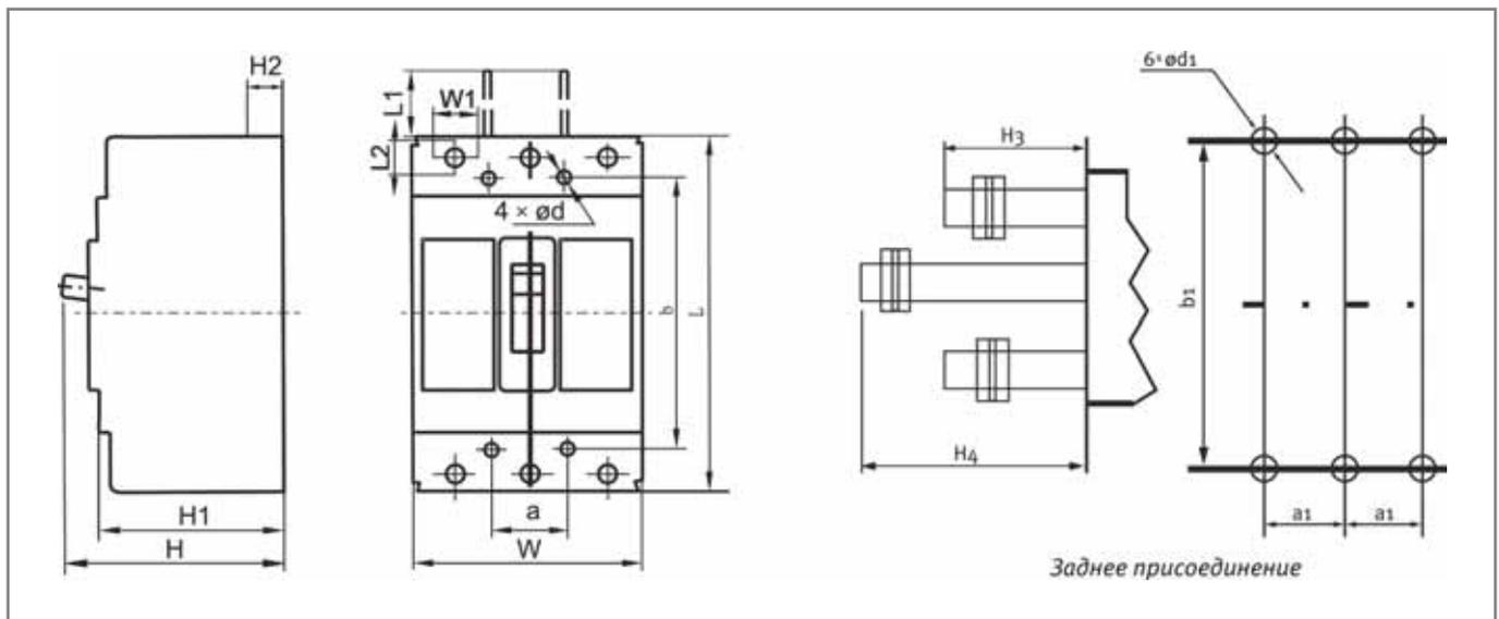
Установочные размеры автоматических выключателей серии ВА-300 при заднем присоединении
