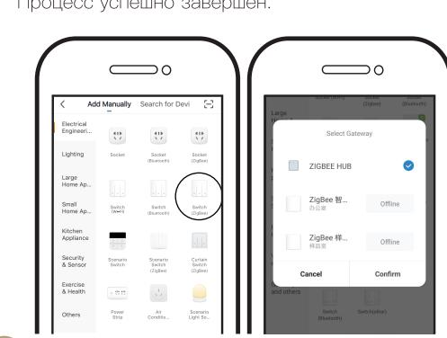
1 Откройте приложение, нажмите на "+" в правом верхнем углу, выберите "Switch (Zigbee)" [Выключатель (Zigbee)], чтобы добавить устройство. И выберите правильный Gateway [Шлюз] для подтверждения подключения.
